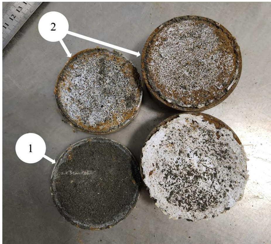
Рисунок 3.10 – Характер взаимодействия мерзлого грунта, слоя гидроизоляции и цементного раствора, изготовленного с комплексной химической добавкой: 1 — заливка через 24 часа после гидроизоляции; 2 — сразу после гидроизоляции
