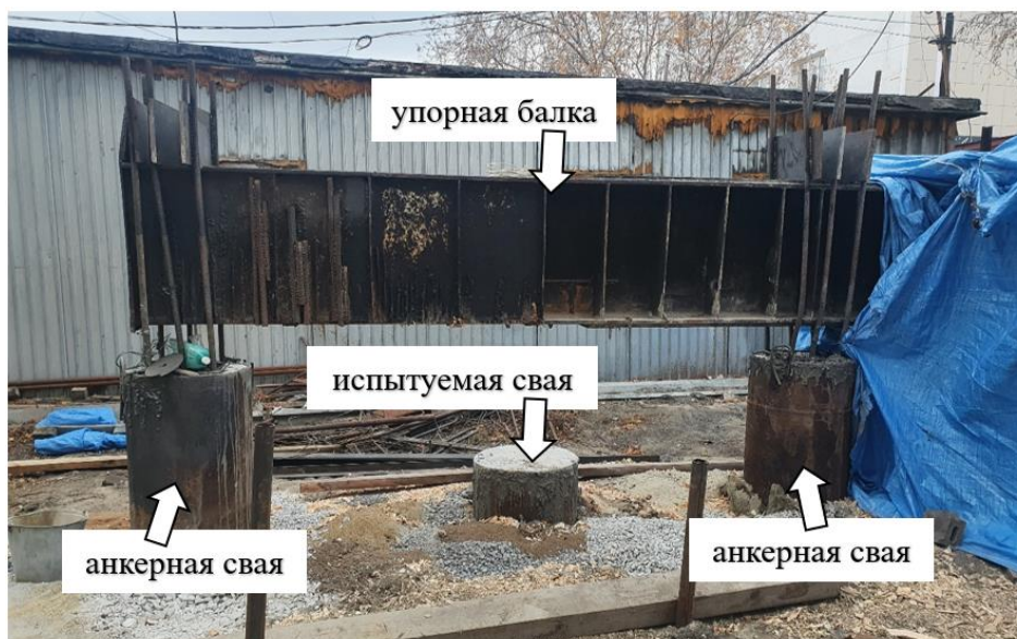
Рисунок 2.9 – Общий вид стенда для проведения испытаний свай
