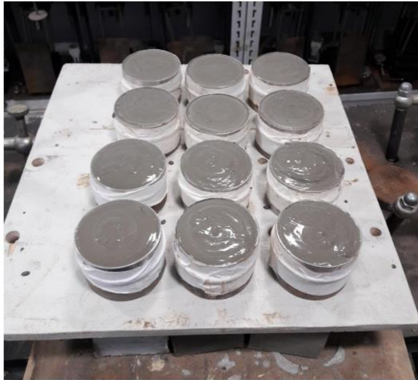
Рисунок 2.3 – Общий вид образцов для испытаний на одноплоскостной срез
