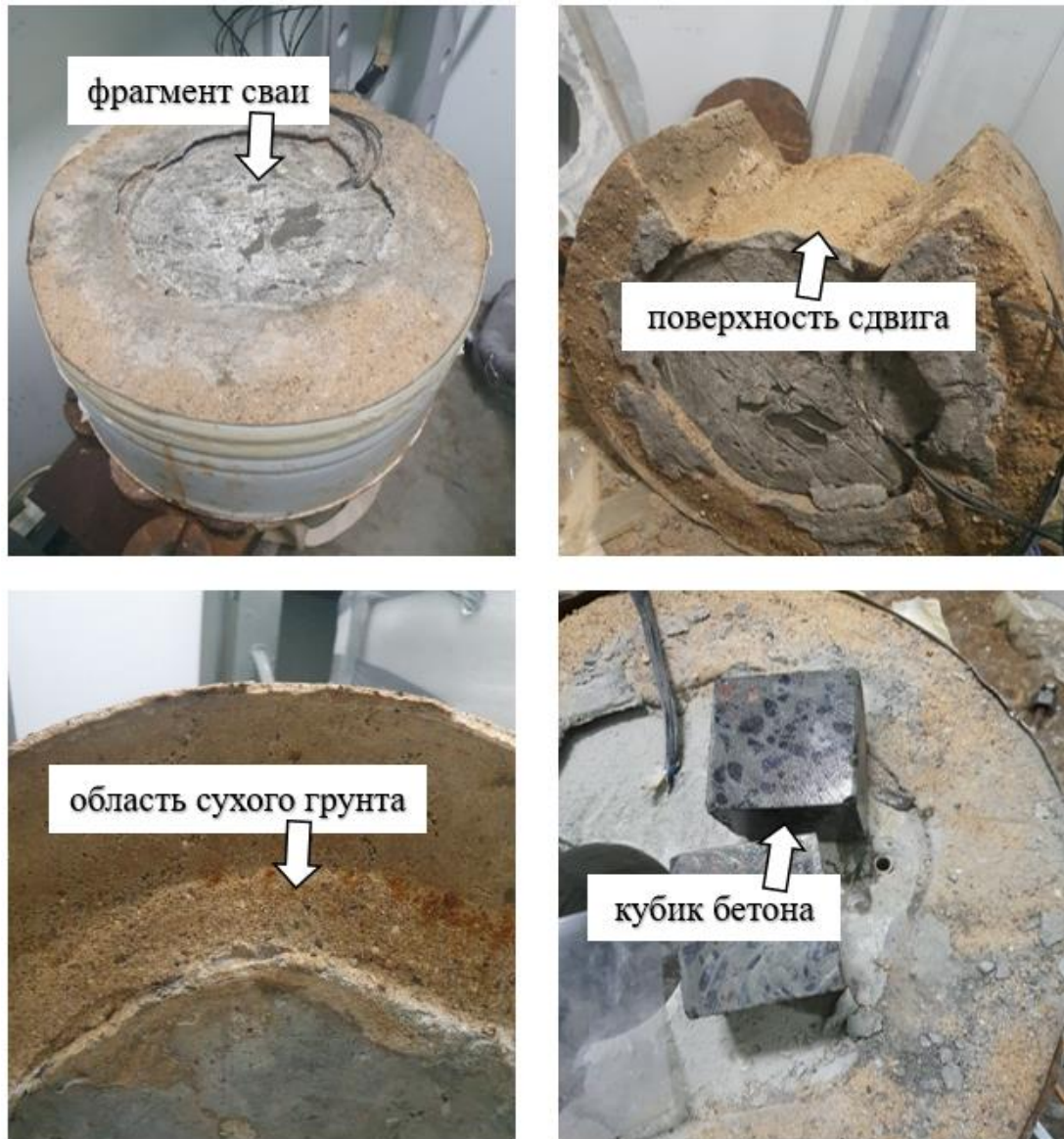
Рисунок 3.17 – Результаты статических испытаний фрагментов буронабивных свай в мерзлом грунте
