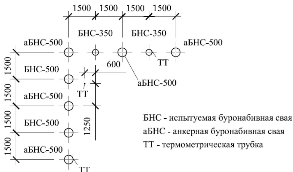
Рисунок 2.6 – План расположения испытываемых свай
