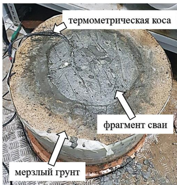
Рисунок 2.5 – Общий вид лотка для проведения испытания фрагмента сваи
